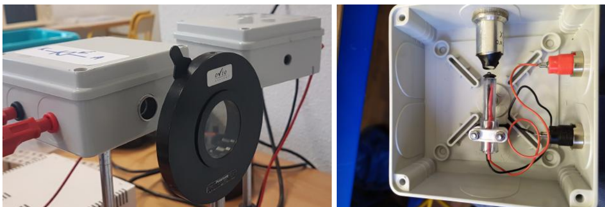
FIGURE 12 – Photo de gauche : à l'arrière, la boîte qui contient la diode laser, l'analyseur et à l'avant la boîte avec la photodiode. Photo de droite : objectif de microscope, filtre et photodiode
