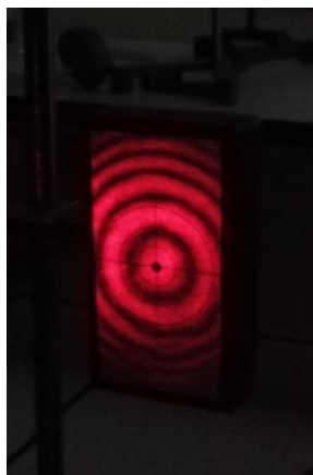
Figure d'interférence (obtenue avec une configuration en lame d'air) projetée sur notre photodiode.
